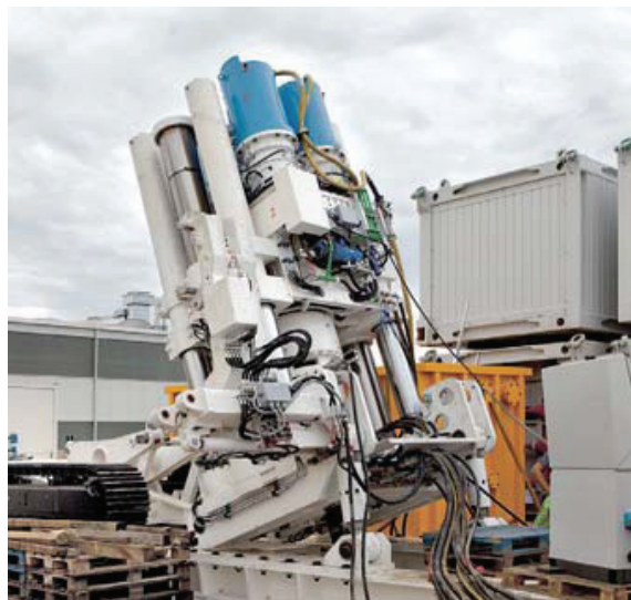
Рис. 1. Мобильная установка для проходки восстающих RBR
