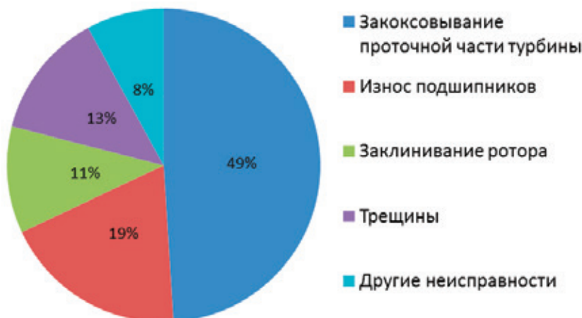
Рис. 1. Анализ причин неисправностей турбокомпрессора
