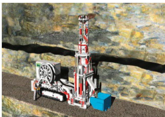
Рис. 2. Мобильная установка для проходки восстающих ВВМ
