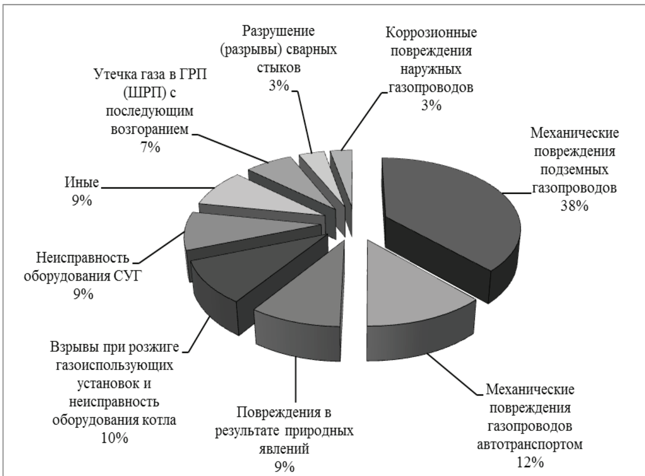
Рис. 1. Распределение долей видов аварий в общем количестве аварий, произошедших на ОПО газораспределения и газопотребления за период 2010–2014 гг.
