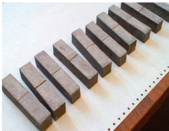
Рис. 2. Образцы размерами 25 × 25 × 100 мм с U-образным концентратором напряжений
