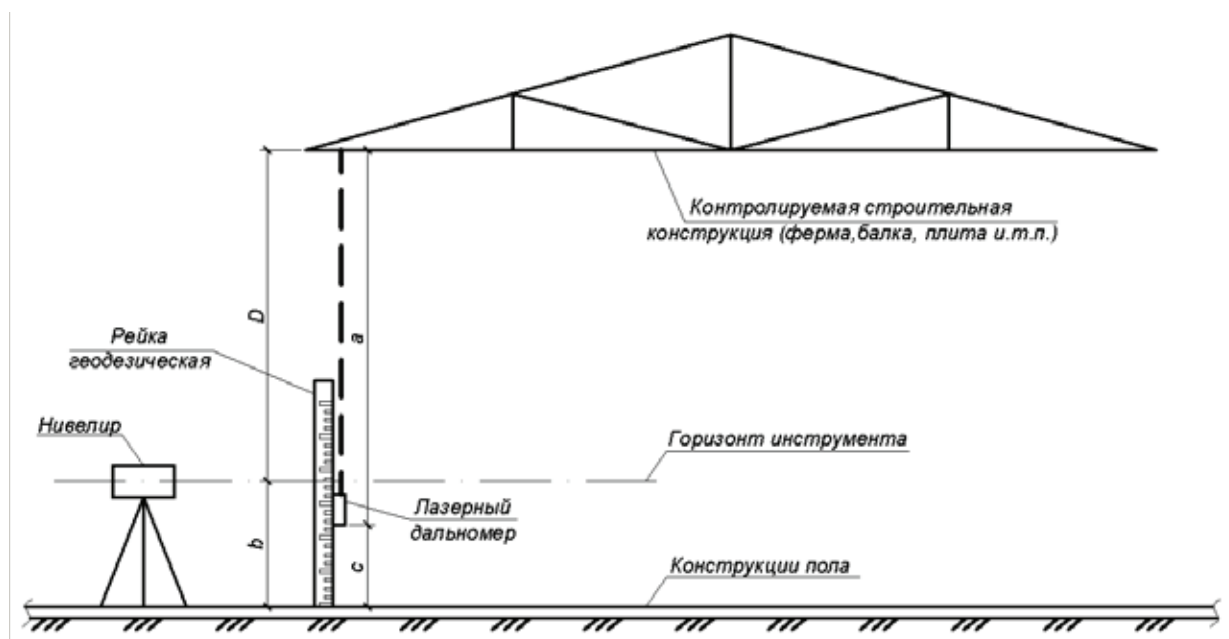
Рис. 1 Принципиальная схема измерения высотных отметок стропильной конструкции
