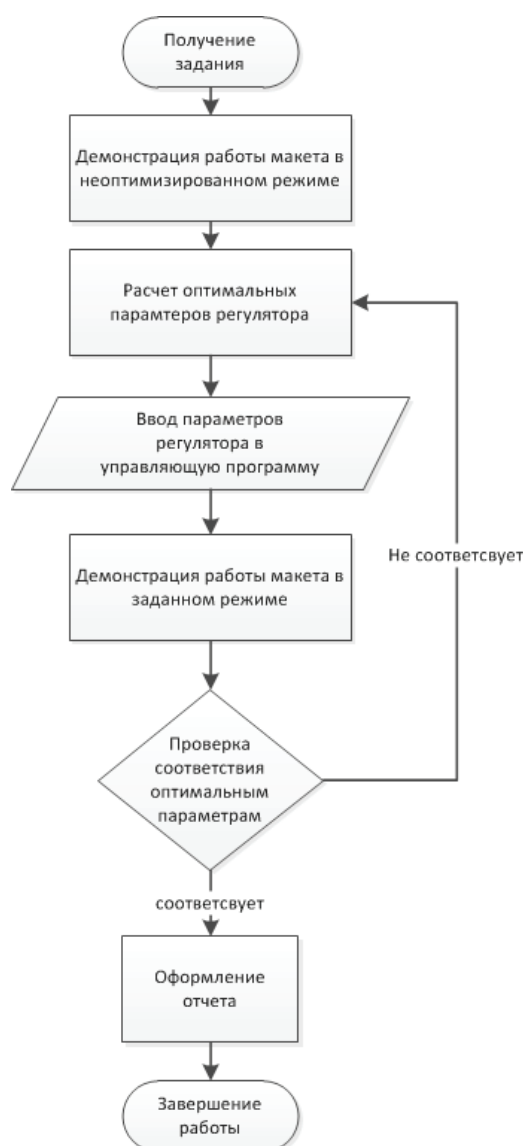
Рис. 2. Алгоритм проведения лабораторной работы с помощью предлагаемого макета
