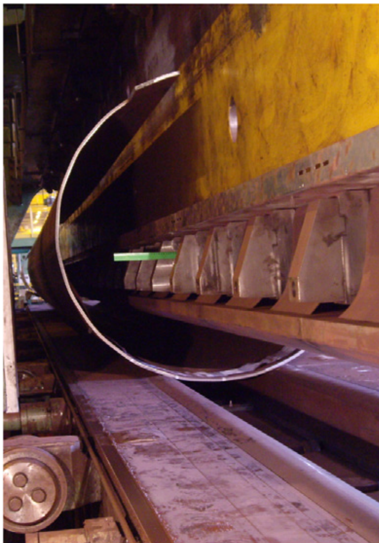
Рис. 6. Изгиб стального листа на трубоформовочном прессе SMS Meer
