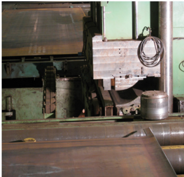
Рис. 5. Изгиб кромки стального листа на кромкогибочном прессе SMS Meer
