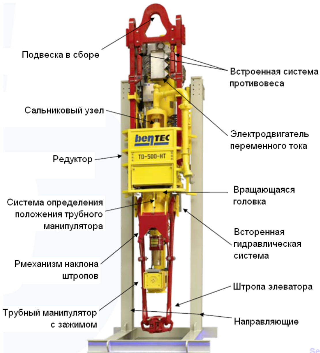
Рис. 1. Схема силового верхнего привода Бентек
