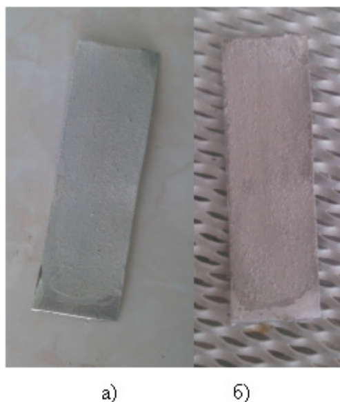
Рис. 3. Металлическая деталь, покрытая краской при комнатной температуре (а), и после отжига при 873 К в течение 30 мин (б)
