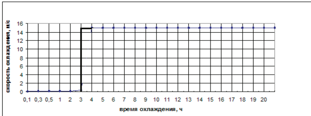
Рис. 2. Изменение скорости охлаждающего воздуха в течение времени охлаждения
