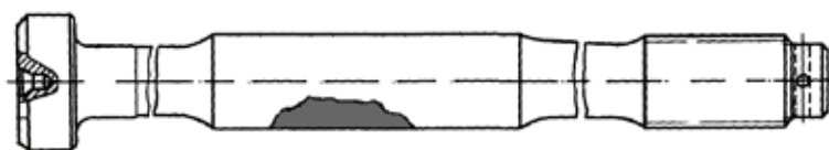
Рис. 5. Место образования фреттинг-коррозии на шатунном болте
