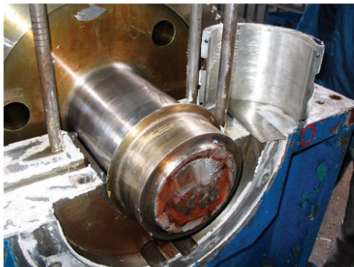
Рис. 8. Обрыв конца зубчатого вала-колеса редуктора центробежного компрессора вследствие фреттинг-износа (материал зубчатого вала-колеса — сталь 40ХНМА)
