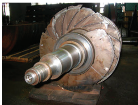
Рис. 7. Коррозионное повреждение рабочих колес центробежного компрессора
