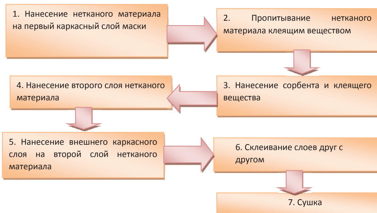
Рис. 2. Технологическая схема изготовления маски
