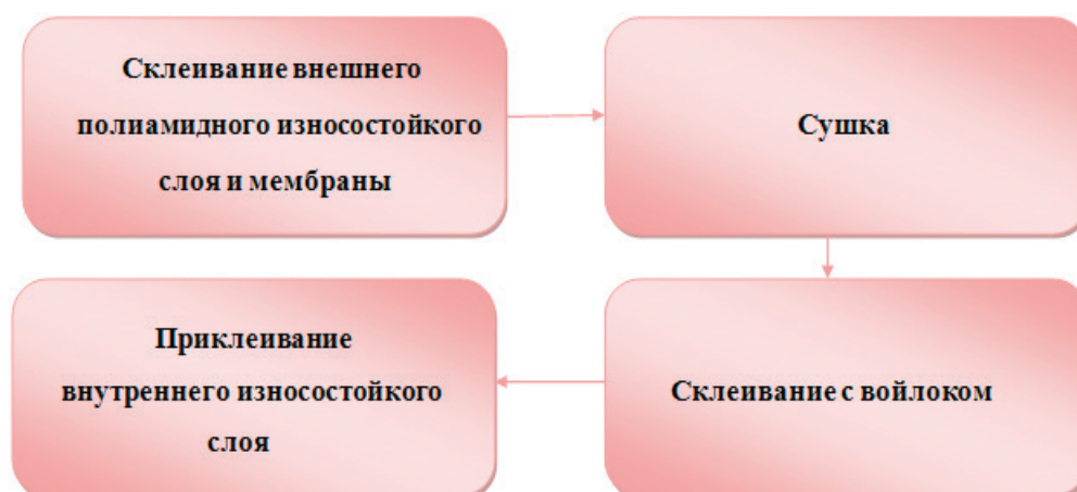
Рис. 1. Блок-схема изготовления материала
