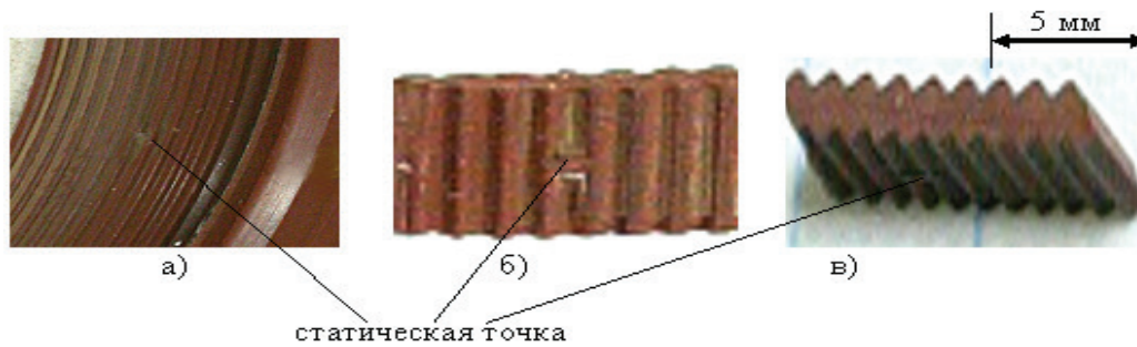
Рис. 2. Сальник 7406–1005160 МКВ: а — сегмент сальника после наработки 400 ч, б — вырезанный фрагмент «губы», в-сечение «губы»
