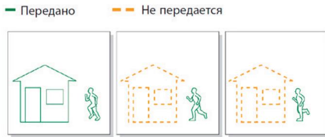
Рис.1. Понятие работы межкадрового кодирования в стандарте MPEG-4
