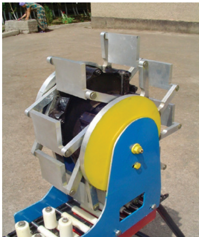
Рис. 1. Новая конструкция устройства для резки непрерывного пластичного бруса мыла
