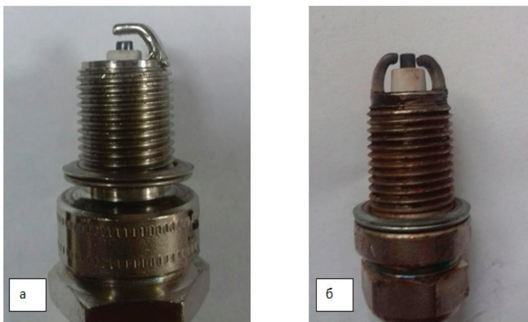
Рис. 1. Свечи зажигания, использованные в эксперименте: а) одноэлектродная свеча АУ17 ДВРМ; б) двухэлектродная свеча Equem RFC58122E
