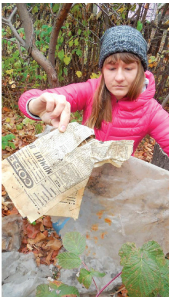
Рис.2. Полиэтиленовая плёнка, пролежавшая на открытом воздухе с 25 февраля 1983 года по 20. 08.2014 года
