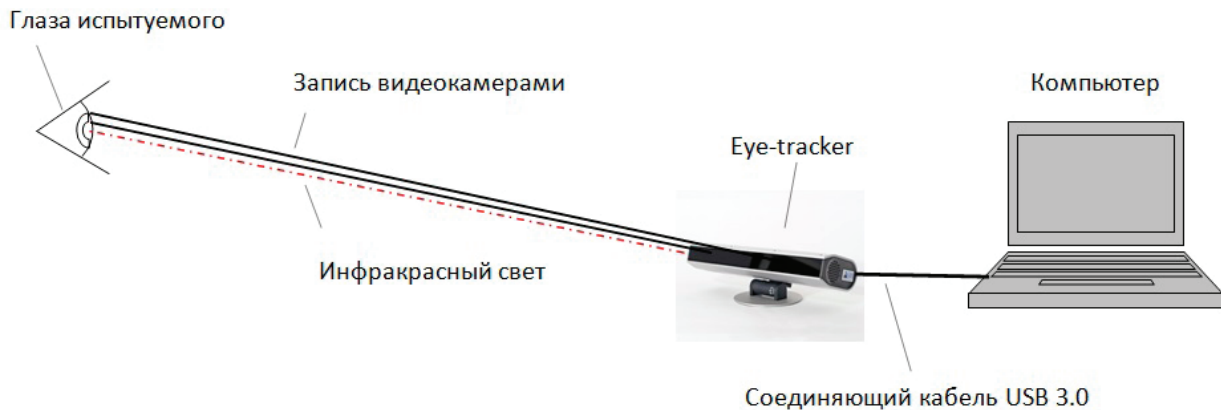
Рис.2. Схема работы прибора eye-tracker
