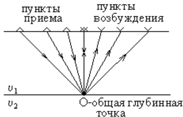
Рис. 1. Метод общей глубинной точки
