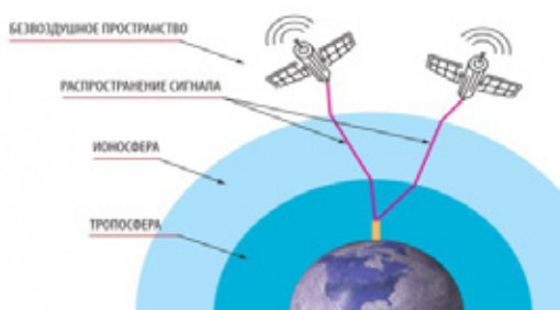
Рис. 1. Преломление радиоволны за счет перехода из границы раздела сред с различными диэлектрическими проницаемостями \epsilon
