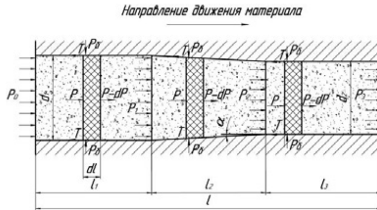
Рис. 3. Схема сил, действующих на материал в канале матрицы
