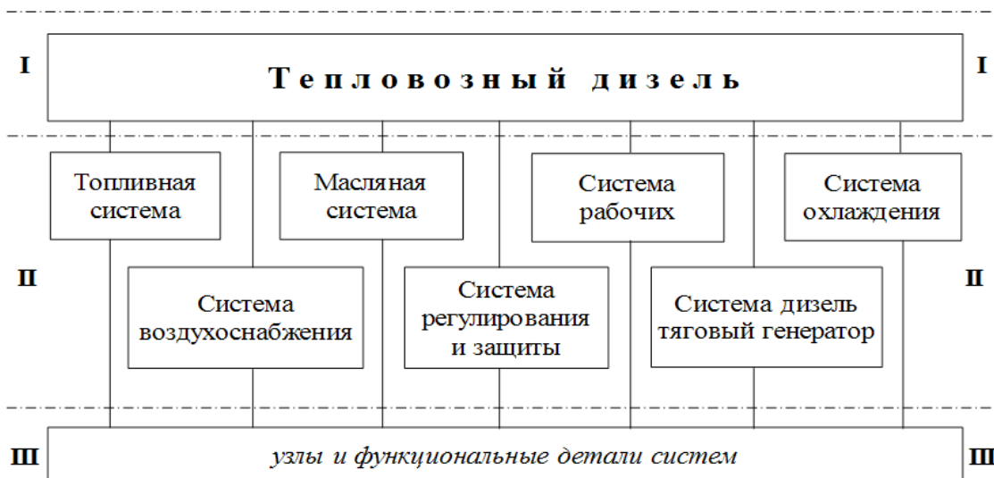
Рис. 1. Функционально взаимосвязанные подсистемы дизельной энергетической установки 1А-5Д49-2
