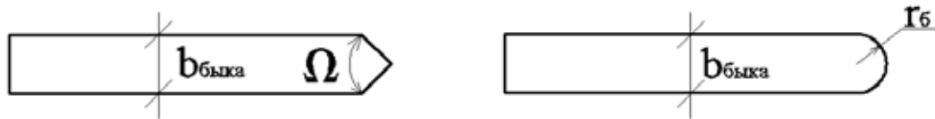
Рис. 3. Форма направляющих быков: а — остроконечная, б — скругленная
