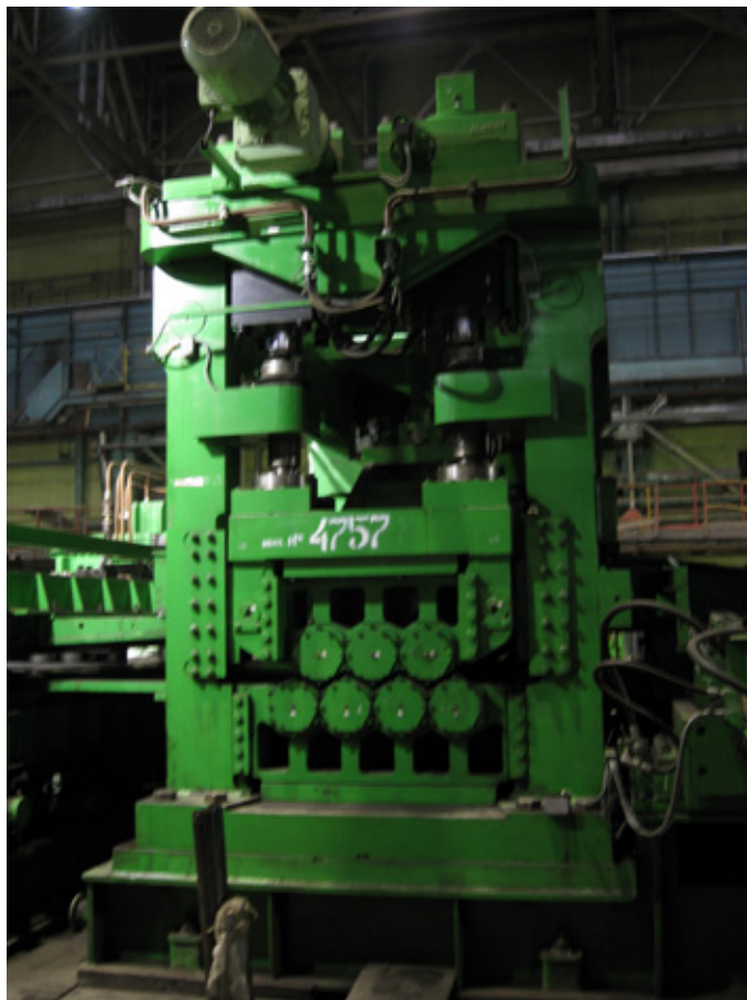
Рис. 1. Семироликовая листопрямильная машина
