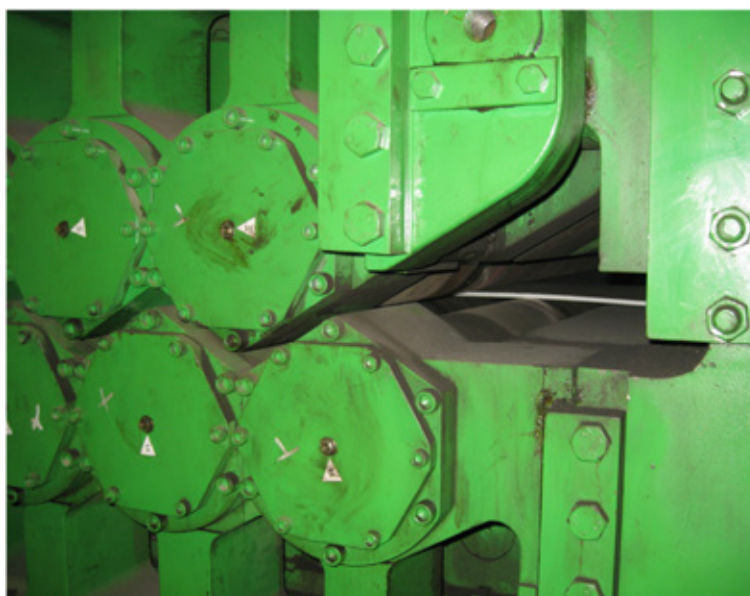
Рис. 2. Стальной лист между рабочими роликами семироликовой листопрямильной машины
