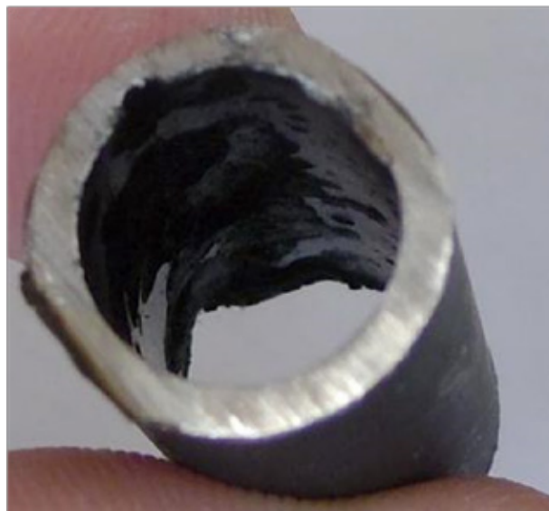
Рис. 4. На внутренней поверхности образца видны многочисленные повреждения в виде раковин
