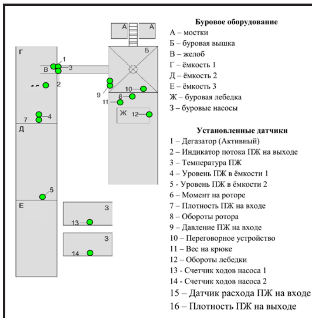
Рис. 4. Схема расположения датчиков
