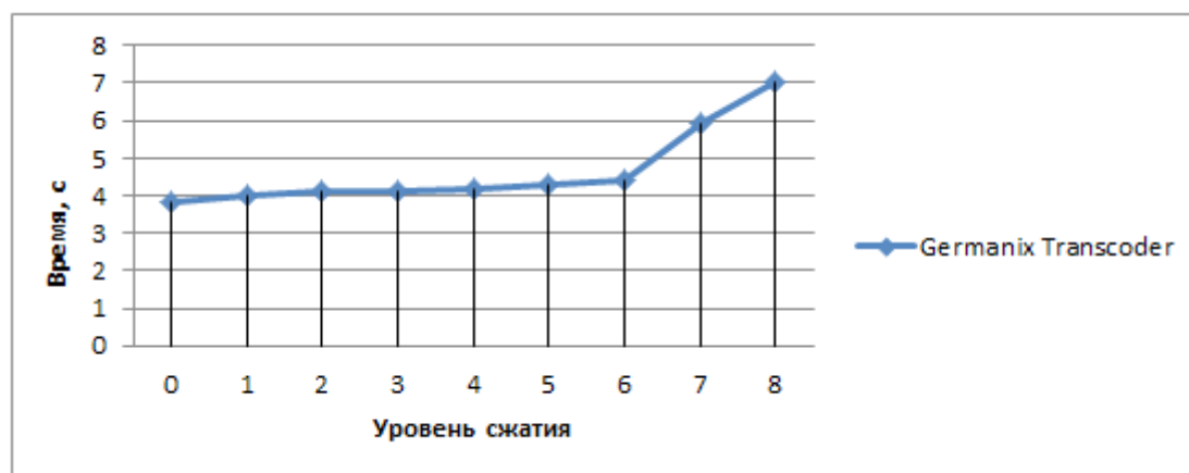
Рис. 4. Соотношение уровень сжатия — время при сжатии кодеком Flac в программе Germanix Transcoder
