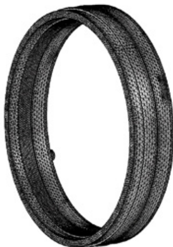
Рис. 3. Вид конечно-элементной сетки
