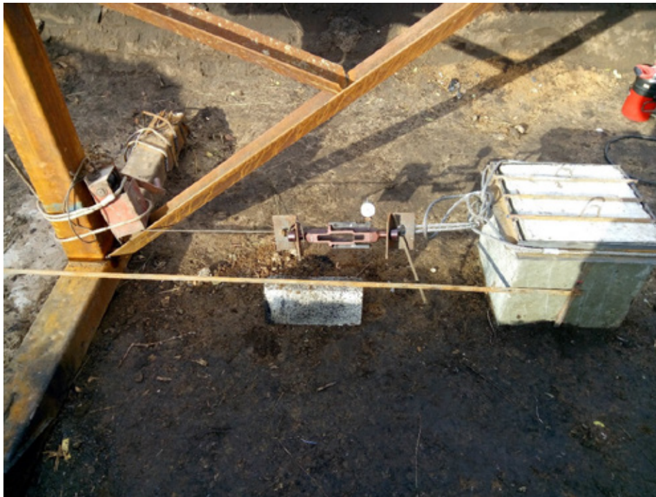
Рис. 8. Испытание односвайно-плитного фундамента на статическую горизонтальную нагрузку с изгибающим моментом
