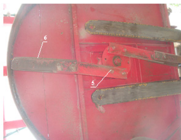
Рис. 1. Полевая установка с интенсивным измельчающим аппаратом: 1 — карданный вал; 2 — конический редуктор; 3 — шкив; 4 — полозья (лыжи); 5 — ножевой узел; 6 — нож (лезвие)
