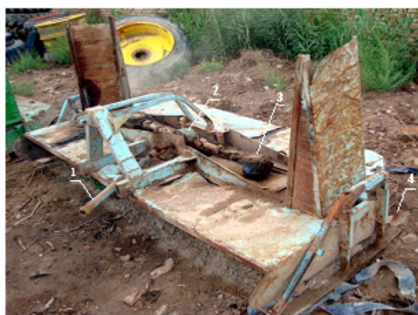
Рис. 1. Полевая установка с интенсивным измельчающим аппаратом: 1 — карданный вал; 2 — конический редуктор; 3 — шкив; 4 — полозья (лыжи); 5 — ножевой узел; 6 — нож (лезвие)
