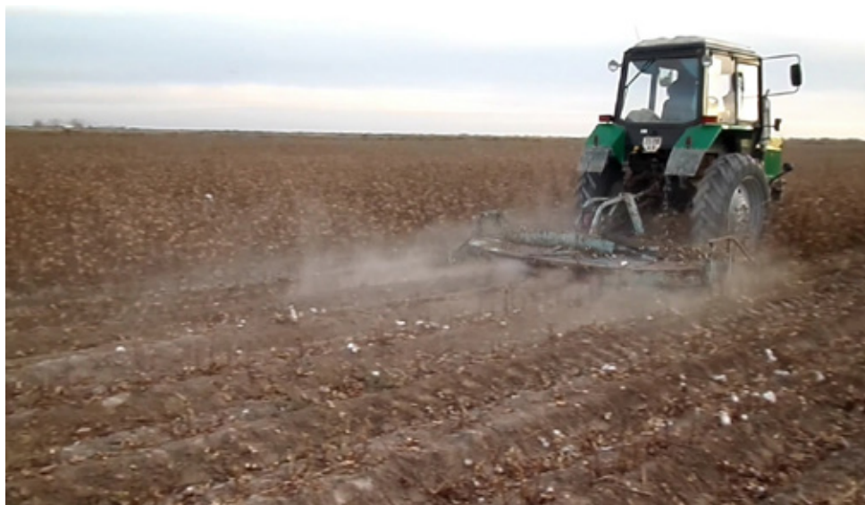
Рис. 5. ИСХ-3,6 измельчитель стеблей хлопчатника в полевых условиях
