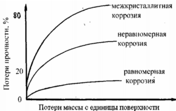
Рис. 2. График зависимости изменения прочности от коррозионных потерь
