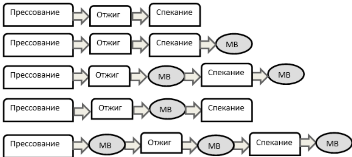
Рис. 1. Технологическая схема получения образцов
