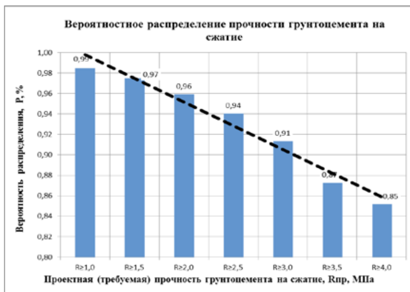
Рис. 4. Осреднённый график вероятностного распределения прочности грунтоцемента на сжатие (для песков пылеватых, суглинков текучих и супесей пластичных)
