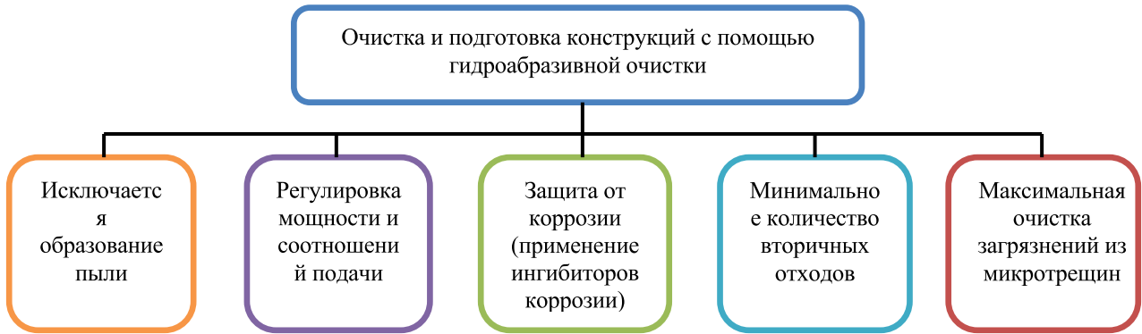
Рис. 1. Преимущества очистки и подготовки конструкций с помощью гидроабразивной очистки
