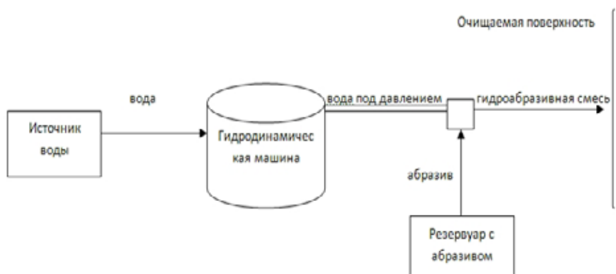
Рис. 3. Гидроабразивная очистка инжекционным способом
