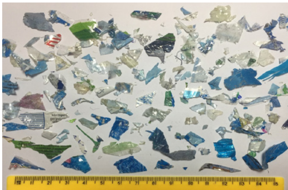
Рис. 2. Общий вид этикеточного флекса, образующегося при переработке ПЭТ-упаковки
