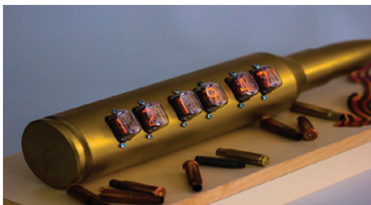
Рис. 4. Действующая модель часов на радиолампах
