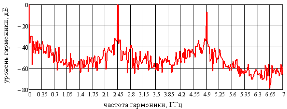
Рис. 1. Спектр сигнала при постоянном анодном напряжении (Частота сигнала \pi -вида f_\pi=2,45 ГГц)
