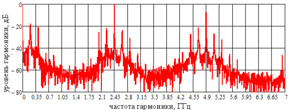
Рис. 2. Спектр выходного сигнала ( B=4 )
