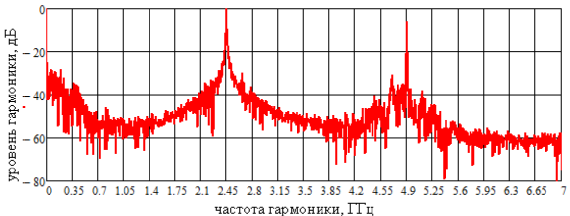
Рис. 3. Спектр выходного сигнала ( B=8 )
