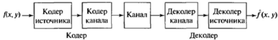
Рис. 1. Общая модель системы сжатия
