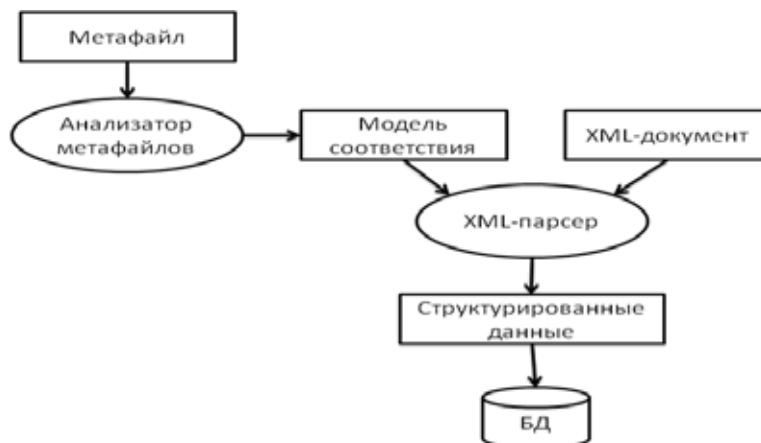
Рис. 2. Схема предлагаемого метода анализа XML-документов
