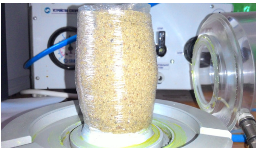
Рис. 1. Песчаный образец после трехосных испытаний, деформированный на 15%
