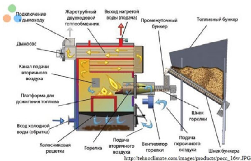
Рис. 1. Пример устройства и функционирования пеллетного котла
