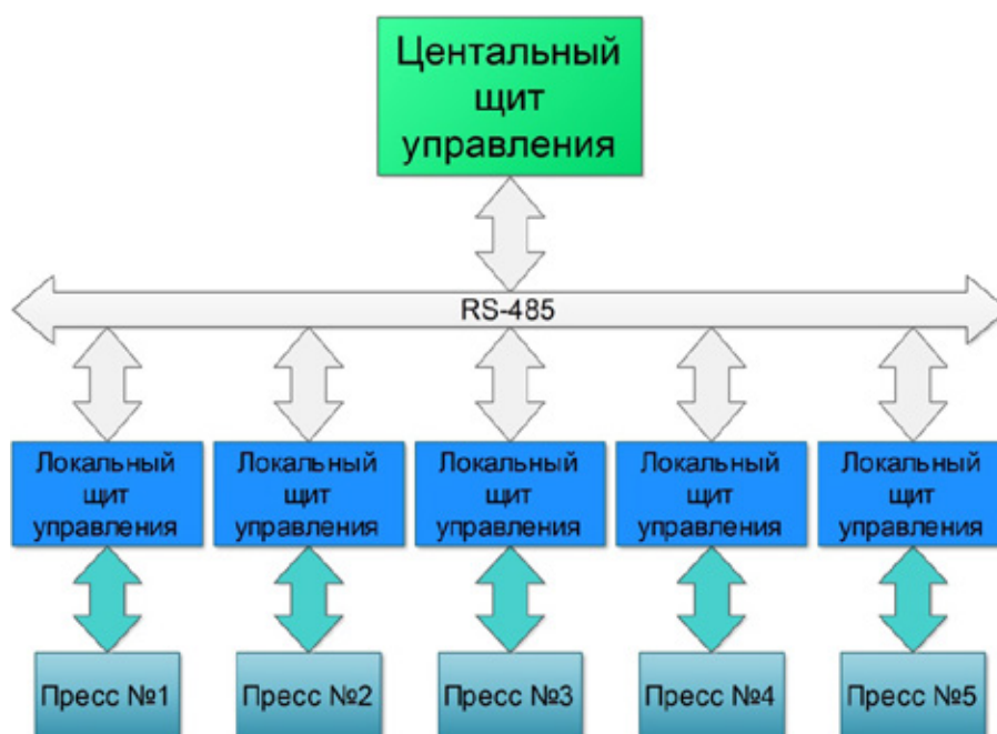
Рис. 2. Структурная схема распределенной АСУТП
