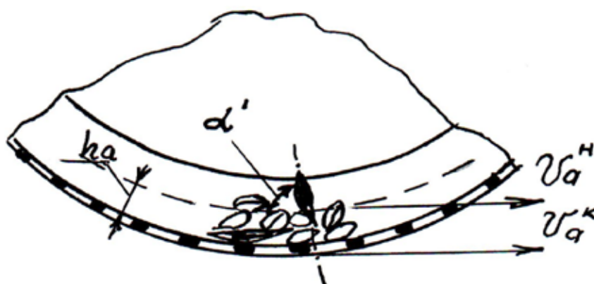
Рис. 2. Процесс разворота длинной частицы в активном слое
