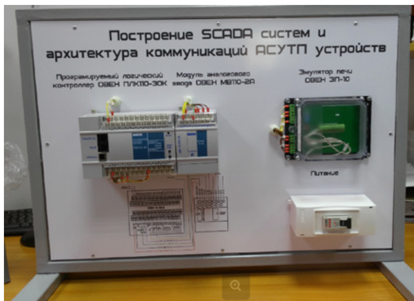
Рис. 18. Разработанный лабораторный стенд для изучения ОМОН ПЛК
