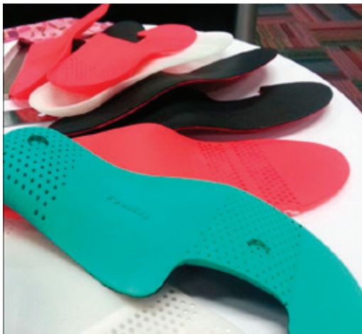
Рис. 2. Персонализированная обувь компании SOLS. Технология трехмерной печати. (а. стельки для обуви; б. обувь «Adaptiv»)
