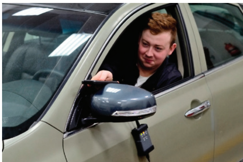
Рис. 3. Диагностический сканер Nissan Consult III+. Оператор мощного стенда студент Васин М. А.
