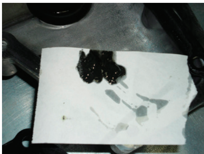
Рис. 16. Снятая с магнитов поддона вариатора грязь
