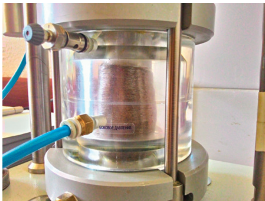
Рис. 2. Испытание песчаного образца в оболочке
