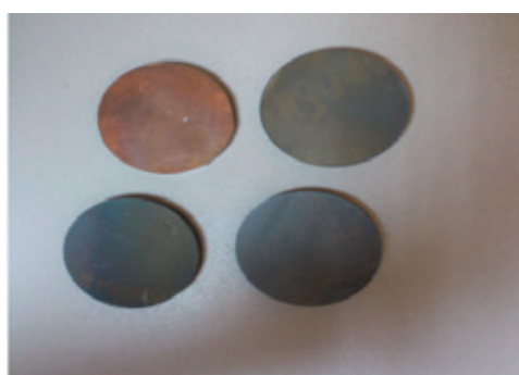
Рис. 4. Катоды из циркония, ниобия, ванадия и меди
