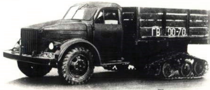
Рис. 1.2. Полугусеничная машина на базе автомобиля ГАЗ-51
