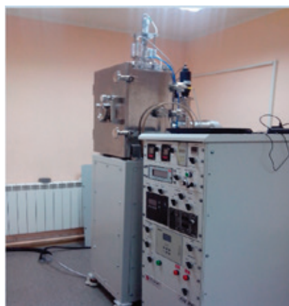
Рис. 3. Установка магнетронного напыления
