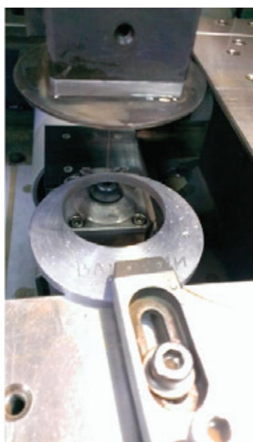
Рис. 6. Образец из ванадия, обработанный на станке Sodick VZ300L
