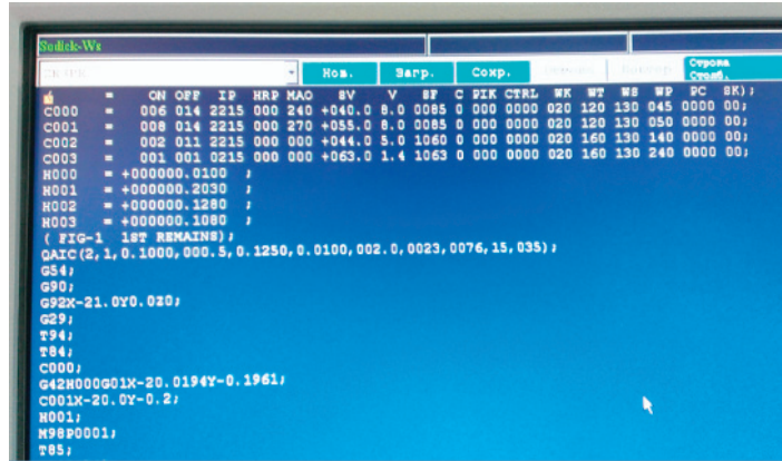
Рис. 7. Режимы резания для 3 проходов
