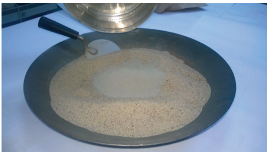
Рис. 2. Присоединение цемента М400 к песку требуемого зернового состава
