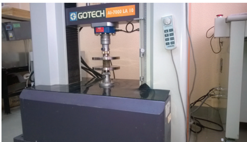
Рис. 4. Одноосное сжатие образца из укрепленного песка при помощи разрывной машины AI-7000 LA 10 в составе измерительно-вычислительного комплекса «GOTECH»
