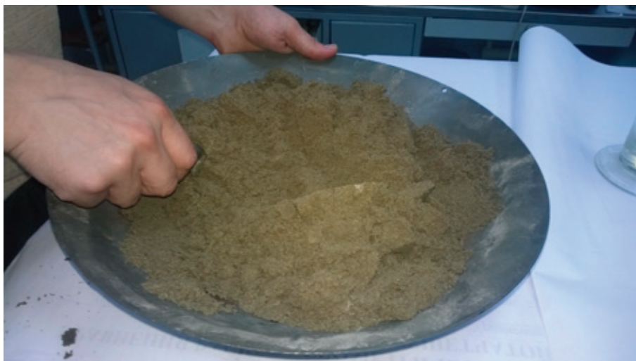
Рис. 3. Приготовление увлажненной цементопесчаной смеси
