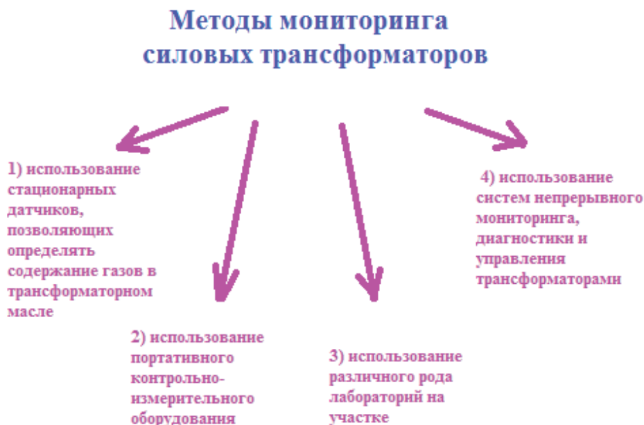
Рис. 1. Существующие методы мониторинга силовых трансформаторов
