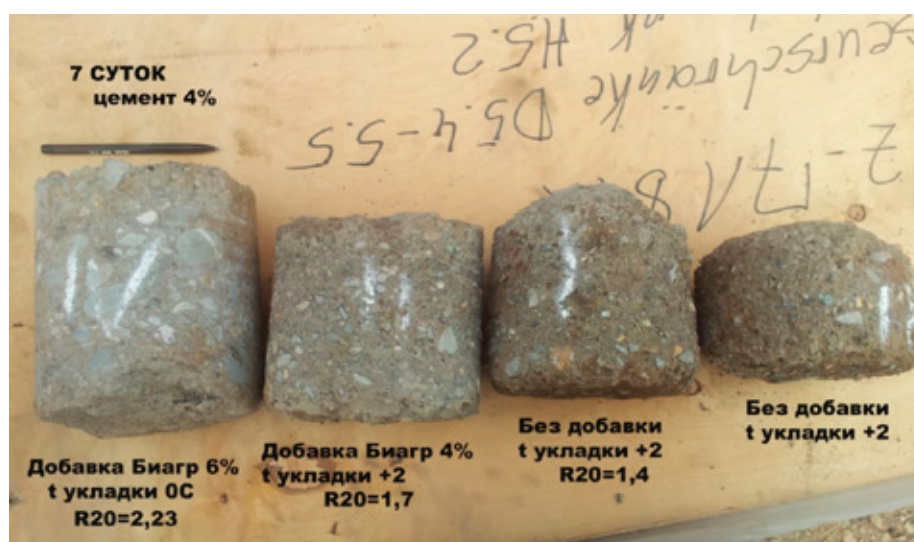
Рис. 1. Керны из асфальтогранулобетонной смеси, отобранные из слоя основания опытно-экспериментального участка через 7 суток
