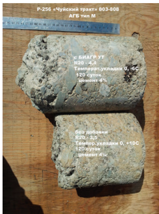
Рис. 2. Керны из асфальтогранулобетонной смеси, отобранные через 120 суток
