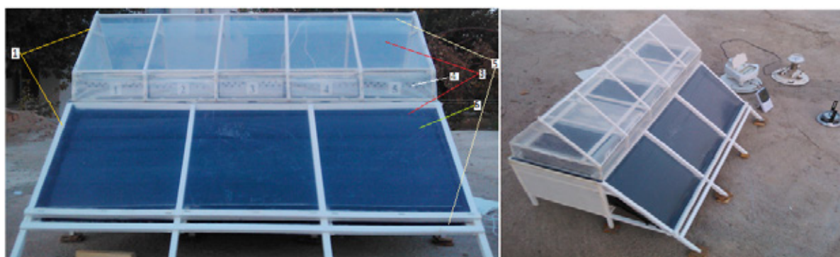
Рис. 1. Вид солнечной сушилки фруктов парникового типа. 1) Верхний и нижний корпус сооружения, представляющий собой деревянный каркас. 2) Стены с трёх сторон сооружения, поверхность которых проводит свет. 3) Посуда, в которую помещаются фрукты, сделанная из нержавеющей стали или из дерева. 4) Щели, которые служат для образования естественной конвекции. 5) Коллектор, который служит для ускорения естественной конвекции.
