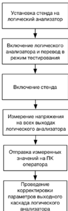
Рис. 2. Порядок работы с разрабатываемым стендом
