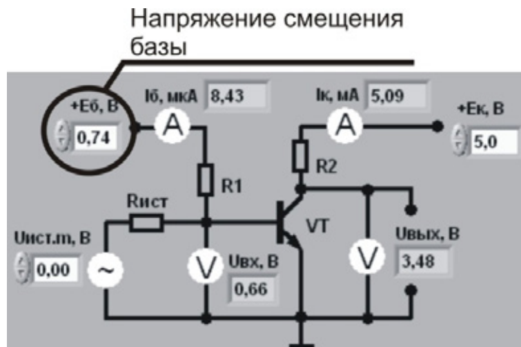
Рис. 5. Цифровой элемент управления напряжением смещения базы
