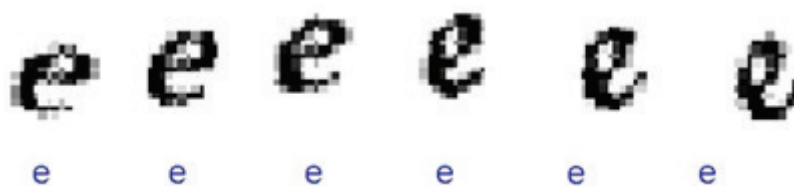
Рис. 6. Пример работы нейронной сети для одной буквы с искажениями (верхние буквы — исходные изображения, нижние — результат работы сети)
