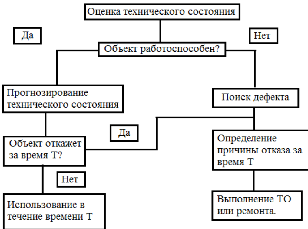
Рис. 3. Последовательность оценки технического состояния транспортного средства
