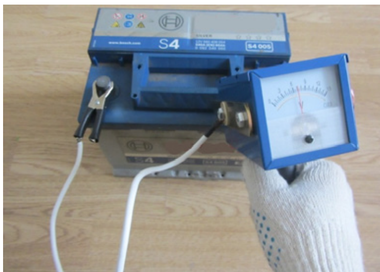
Рис. 3. Измерение заряженности аккумуляторной батареи под нагрузкой
