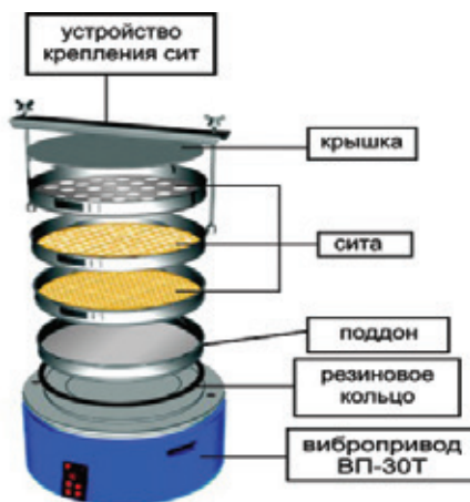
Рис. 2. Вибрационное сито отсеивает крупную фракцию 100–90 мкм
