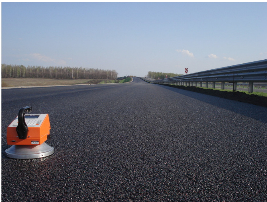
Рис. 1. Экспресс оценка коэффициента уплотнения асфальтобетона
