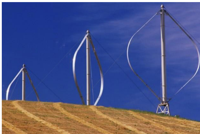
Рис. 1. Ветровые установки с вертикальной осью вращения, на основе ротора Дарье, построенные в Австралии в 1980-х годах
