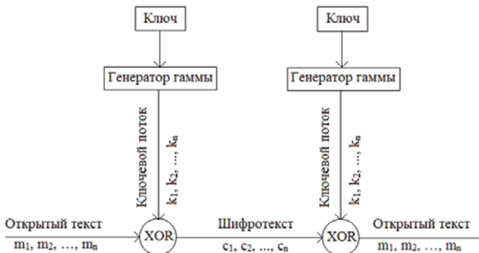
Рис. 1. Принцип работы синхронных потоковых шифров
