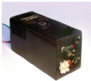
Рис. 2. Управляемый регулятор мощности
