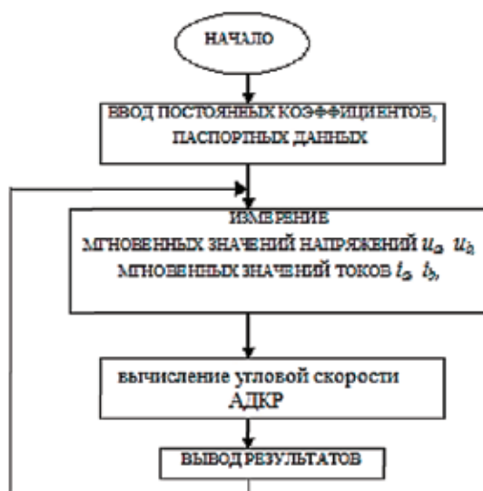
Рис. 1. Алгоритм изменения угловой скорости двигателя в асинхронном приводе
