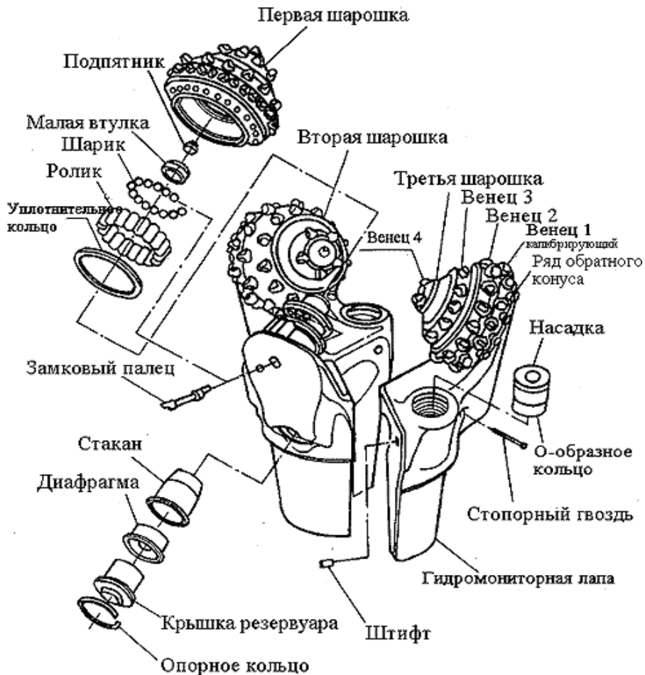
Рис. 2. Составные части шарошечного долота
