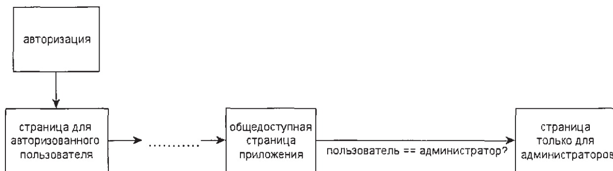
Рис. 2. Пример условия на переходе конечного автомата
