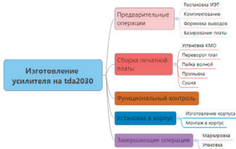
Рис. 2. Концептуально-абстрактная модель усилителя на TDA2030
