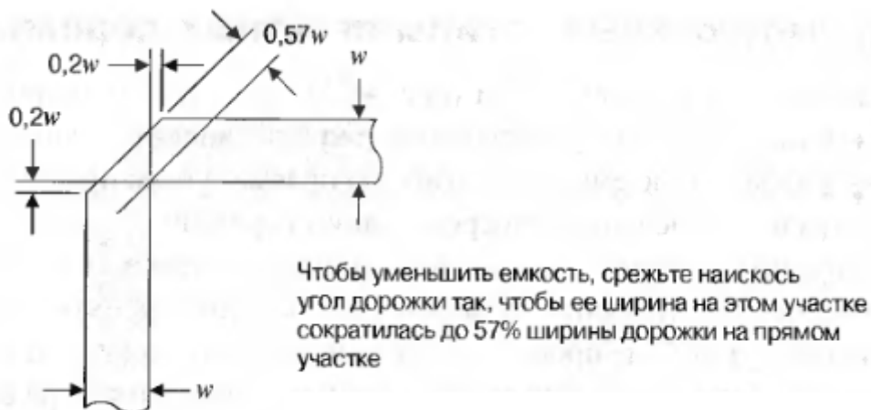
Рис. 4. Обрезка угла на изгибе печатной дорожки с целью уменьшения ёмкостной неоднородности
