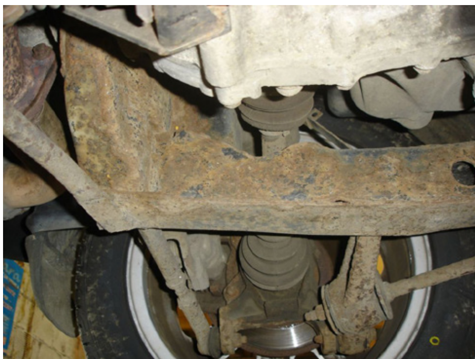
Рис. 2. Днище автомобиля подверженное коррозии
