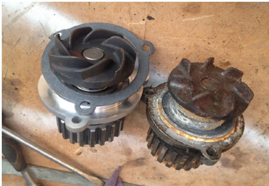
Рис. 2. Новая и изношенная водяная помпа автомобиля ЗАЗ 1102
