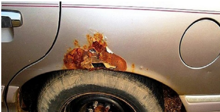
Рис. 2. Пример образования коррозии на крыле автомобиля
