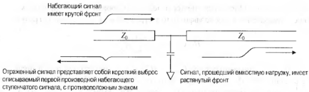
Рис. 1. Емкостная нагрузка, включенная посреди линии передачи
