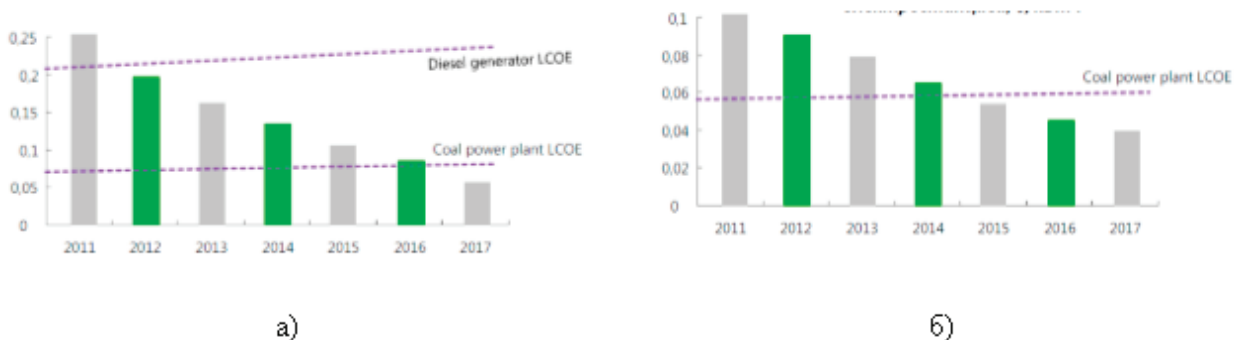
Рис. 4. Стоимость электричества, производимого солнечной (а) и ветровой (б) электростанциями, $ кВтч, [3]
