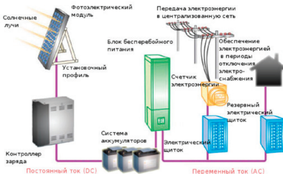
Рис. 1. Схема автономной системы энергоснабжения
