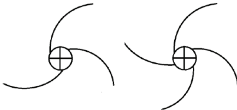
Рис. 4. Ветровые генераторы с веерными концентраторами с тремя (слева) и четырьмя стенами
