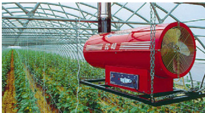
Рис. 2. Пример размещения тепловой пушки в помещении
