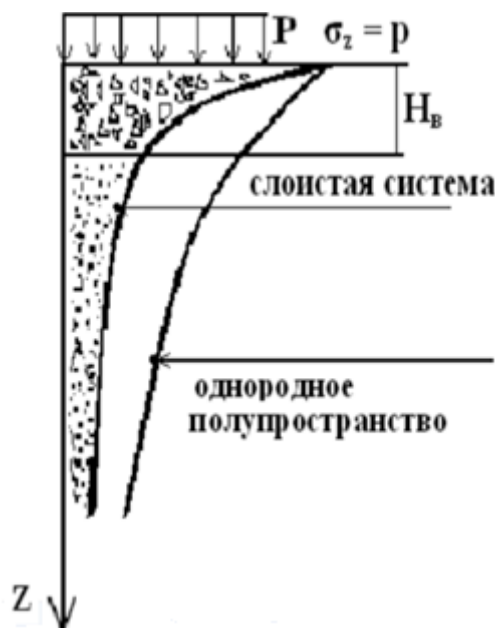
Рис. 5. Распределение напряжений в однородном и слоистом полупространстве
