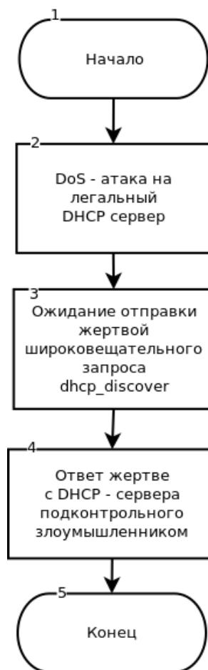
Рис. 3. Блок-схема алгоритма атаки подмены DHCP-сервера
