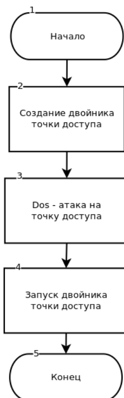
Рис. 1. Блок-схема алгоритма создания двойника выходной точки
