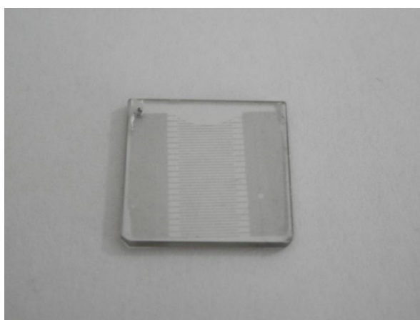
Рис. 3. Управляемая дифракционная решетка на основе ниобата лития x-среза с потенциалами вида v_0v_0 с прозрачными электродами из оксида индия-олова
