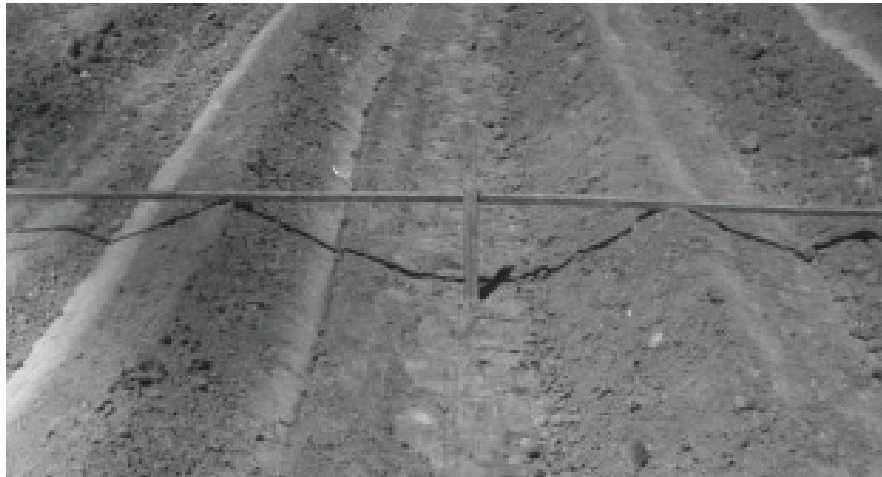
Рис. 2. Профиль временного оросителя
