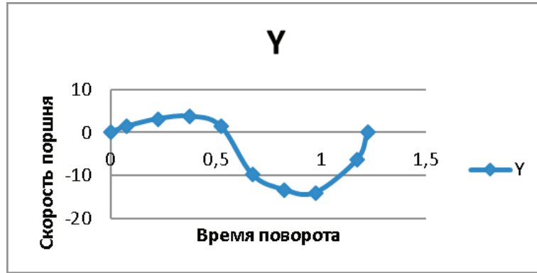
Рис 6. Изменение скорости поршня гидроцилиндра в зависимости от времени поворота лопасти перемешивателя при смещении оси между лопастью и приводом, равном 50 мм.
