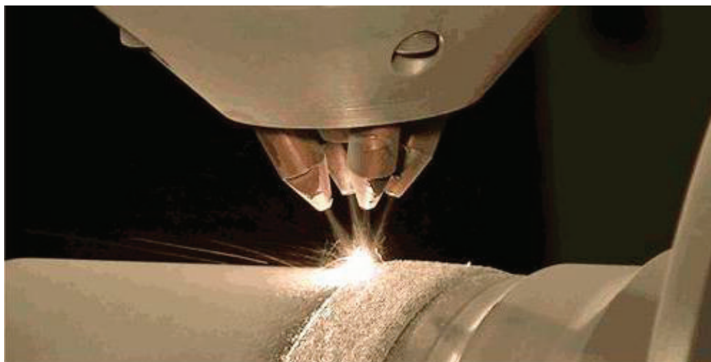
Рис. 3. Обработка 4-мя пучками лазера
