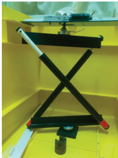
Рис. 2. Модель механической мешалки с применением шарнирной муфты
