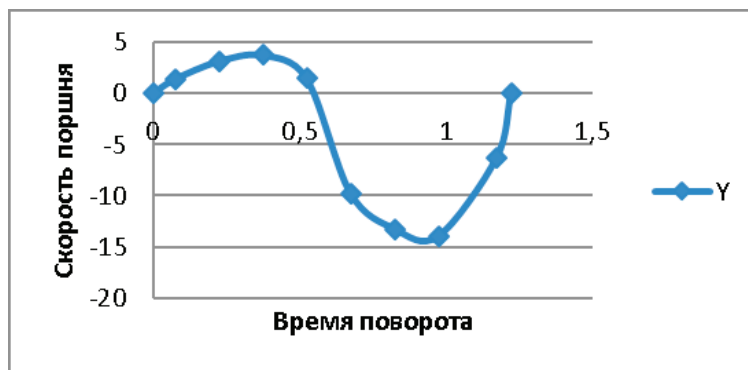
Рис 7. Изменение скорости поршня гидроцилиндра в зависимости от поворота лопасти перемешивателя при смещении оси между лопастью и приводом, равном 80 мм
