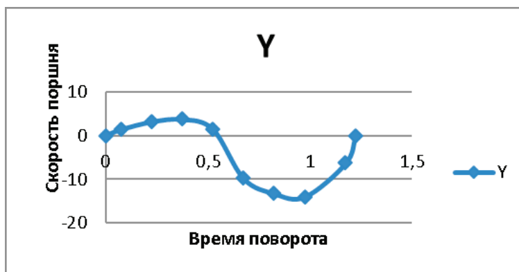
Рис 8. Изменение скорости поршня гидроцилиндра в зависимости от поворота лопасти перемешивателя при смещении оси между лопастью и приводом, равном 130 мм
