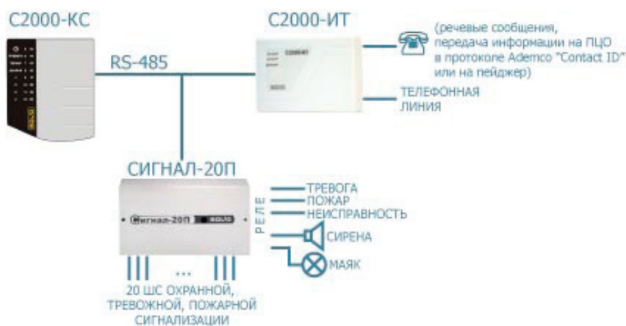
Рис. 3. Схема работы элементов пожарной сигнализации для лакокрасочных предприятий
