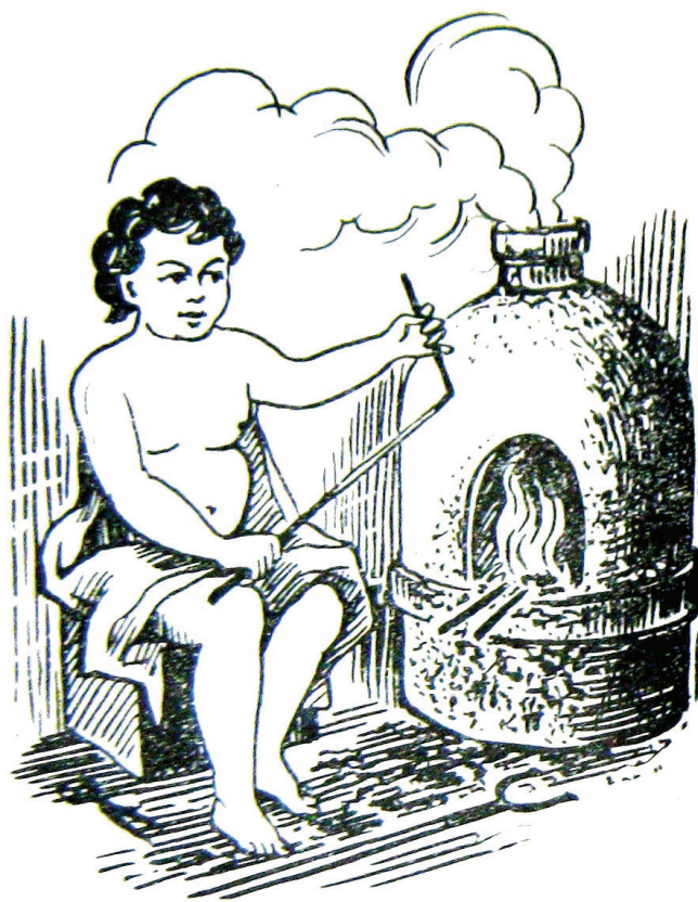
Рис. 1. Вытягивание «пряденого» стекла (по М. В. Ломоносову)
