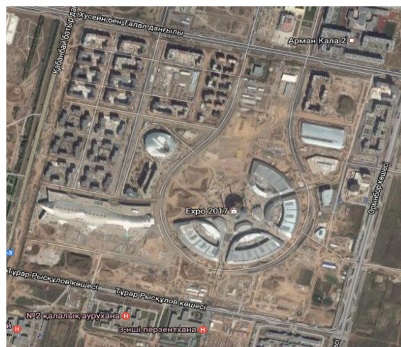
Рис. 4. Использование космических снимков для планирования геодезической сети с использованием спутниковых технологий для сооружений ЭКСПО-2017
