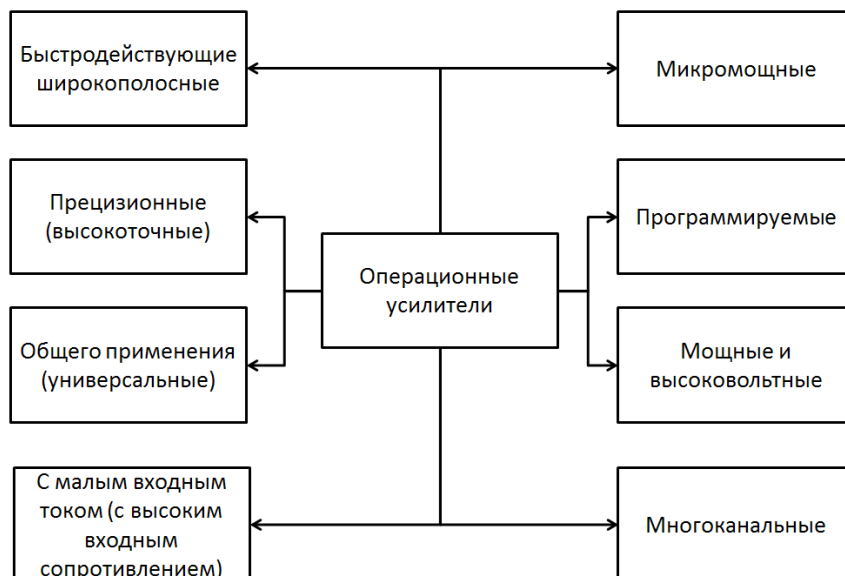
Рис. 2. Классификация ОУ по типам на основе электрических параметров
