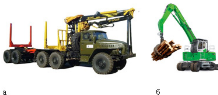
Рис. 12. Техника, применяемая при транспортировании круглого леса: а — лесовоз с гидроманипулятором; б — экскаватор
