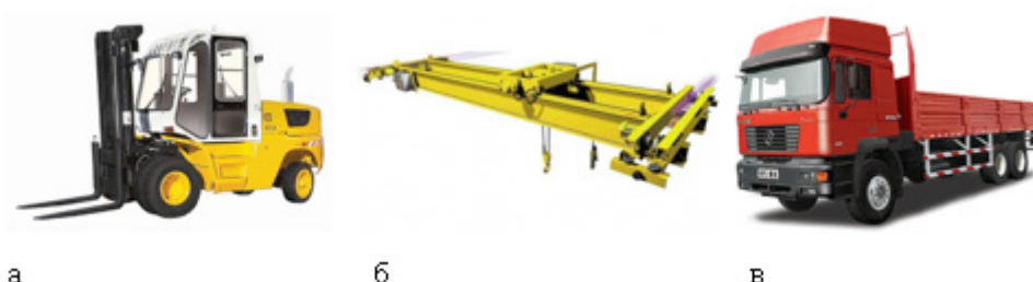
Рис. 14. Виды ПРР и ПС для перевозки пиломатериалов: а — автопогрузчик; б — кран; в — бортовой автомобиль
