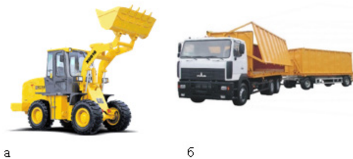
Рис. 16. Виды ПРР и ПС для перевозки отходов лесной промышленности: а) — ковшовый погрузчик; б) — щеповоз
