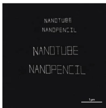
Рис. 5. Применение УНТ на зондах для нанолитографического письма
