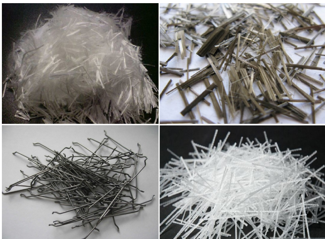
Рис. 1. Различные виды фибры для армирования бетона
