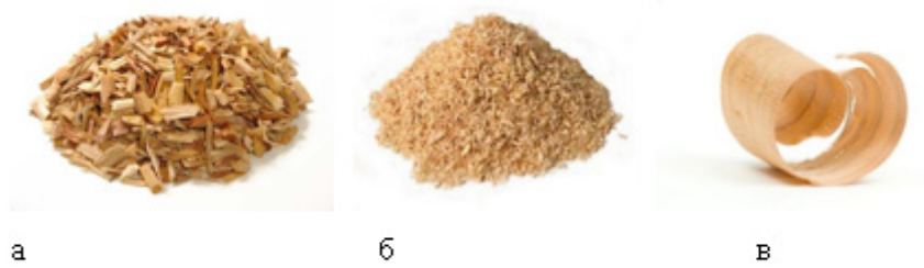
Рис. 15. Виды отходов: а) — щепа; б) — опилки; в) — стружка
