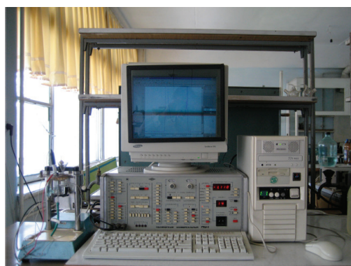
Рис. 2. Компьютеризированный вольт-амперометрический комплекс на базе полярографа ПУ-1 (а); Поляризационные кривые первой волны электровосстановления кислорода на пленочном ртутно-графитовом электроде в 0,05 М фосфатном буфере, рН 6,86. (Отображено на мониторе ПК, работающего в режиме Power Graph 2.0) (б)
