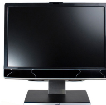
Рис. 2. Устройство eye-tracker Tobii Pro T60XL
