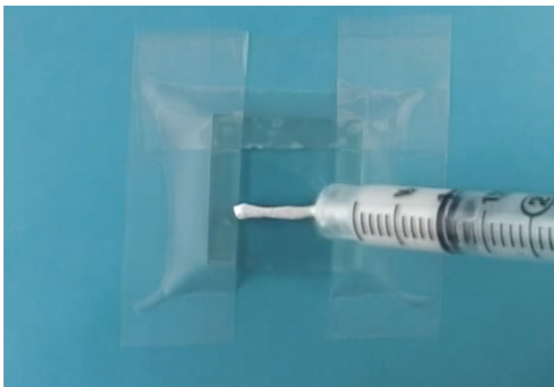
Рис. 1. Нанесение пасты на поверхность стеклянной подложки FTO
