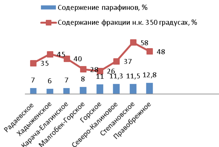
Рис. 3. Изменение фракционного состава вязких парафинистых нефтей в зависимости от месторождения, относящихся к Волго-Уральской и Западно-Сибирской нефтяных систем
