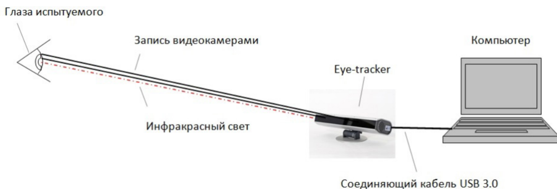
Рис. 1. Схема работы устройства eye-tracker
